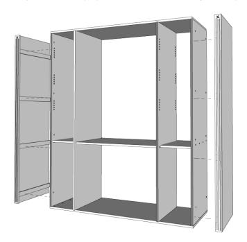
• Необходимо замерить размер корпуса по диагонали. Он должен быть одинаковым с двух сторон. После прикрутить оргалит (ЛХДФ) (7) с применением саморезов с пресс шайбой (22). Рекомендуемый шаг 25 см.
