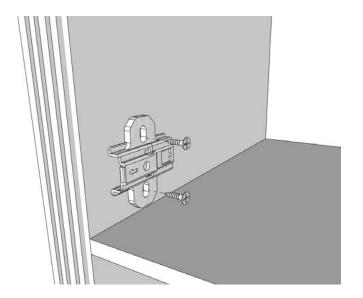
• Сверлим отверстия глубиной не более 10 мм, D 2-2,5 мм. Крепим фасады к стойке саморезами 16 мм (21). Фасады регулируем относительно друг друга с одинаковым зазором.
